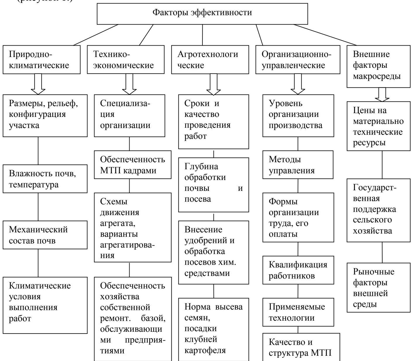
Рис. 1. Факторы, влияющие на эффективность использования машинно-тракторного парка
