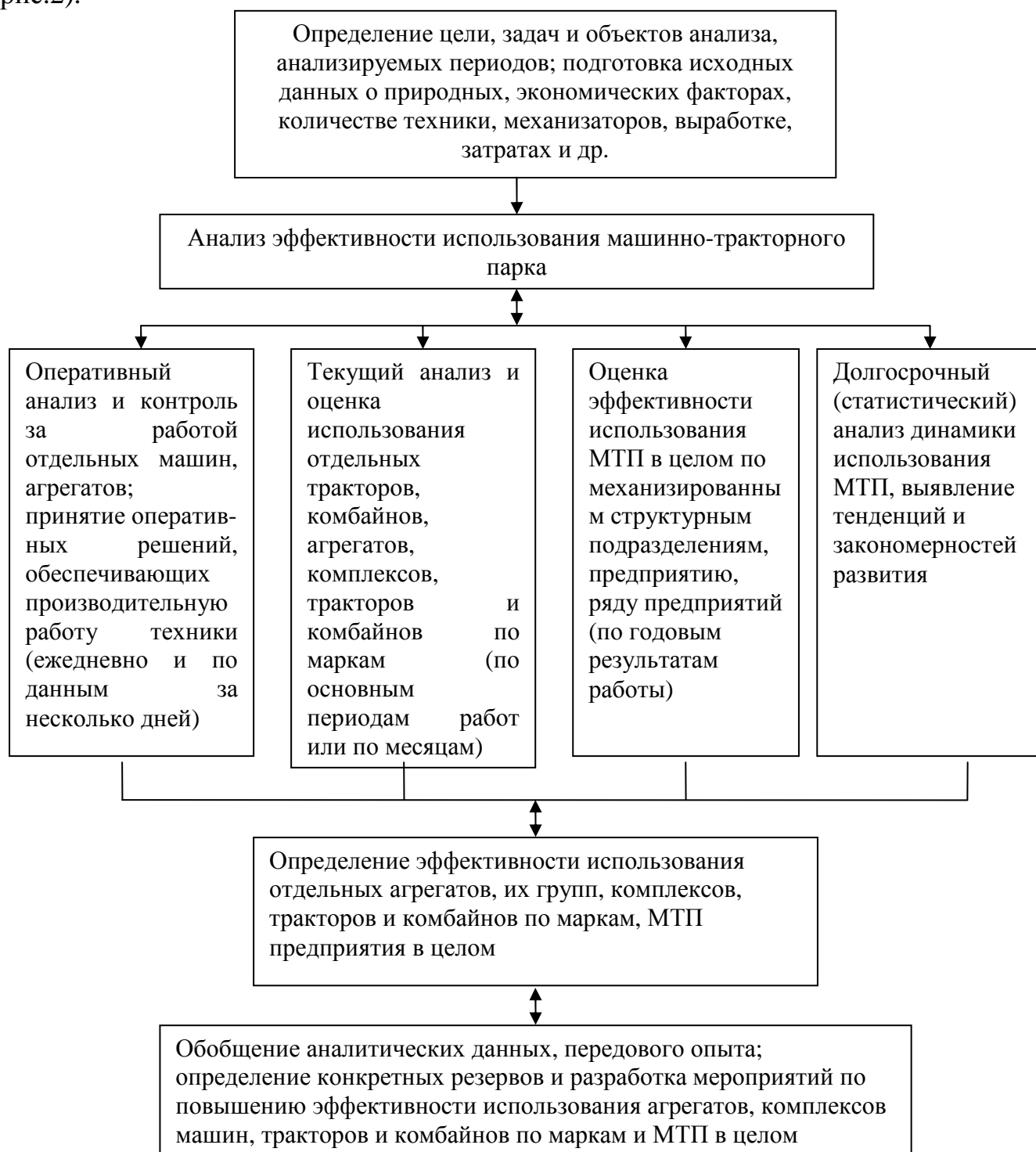
Рис. 2. Алгоритм комплексного анализа эффективности использования машинно-тракторного парка
