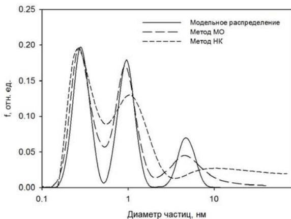
Рисунок 3. Восстановление модельного распределения при прохождении диффузионной батареи из 20 сеток типа (40/2000/8,9).
