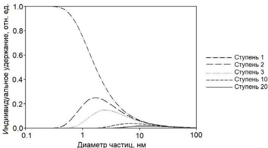
Рисунок 1. Индивидуальное удержание ступеней диффузионной батареи из сеток с толщиной проволоки 65 мкм, шириной раскрытия ячейки 100 мкм и плотностью 8,5 г/см<sup>3</sup> при расходе воздуха 30 л/мин.
